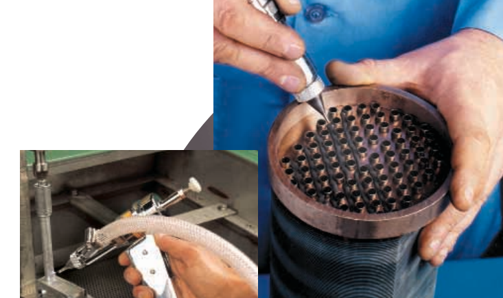
La pistola manuale del dosatore distribuisce uno o più punti o strisce di pasta.
