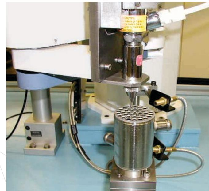
Ce robot applique avec précision un alliage de pâte nickel autour d'une farde de 37 tubes.
