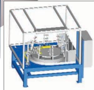
La machine rotative convoie respectivement les pièces montées sur outillage aux stations ; application de brasure, chauffe et cycle de refroidissement.
