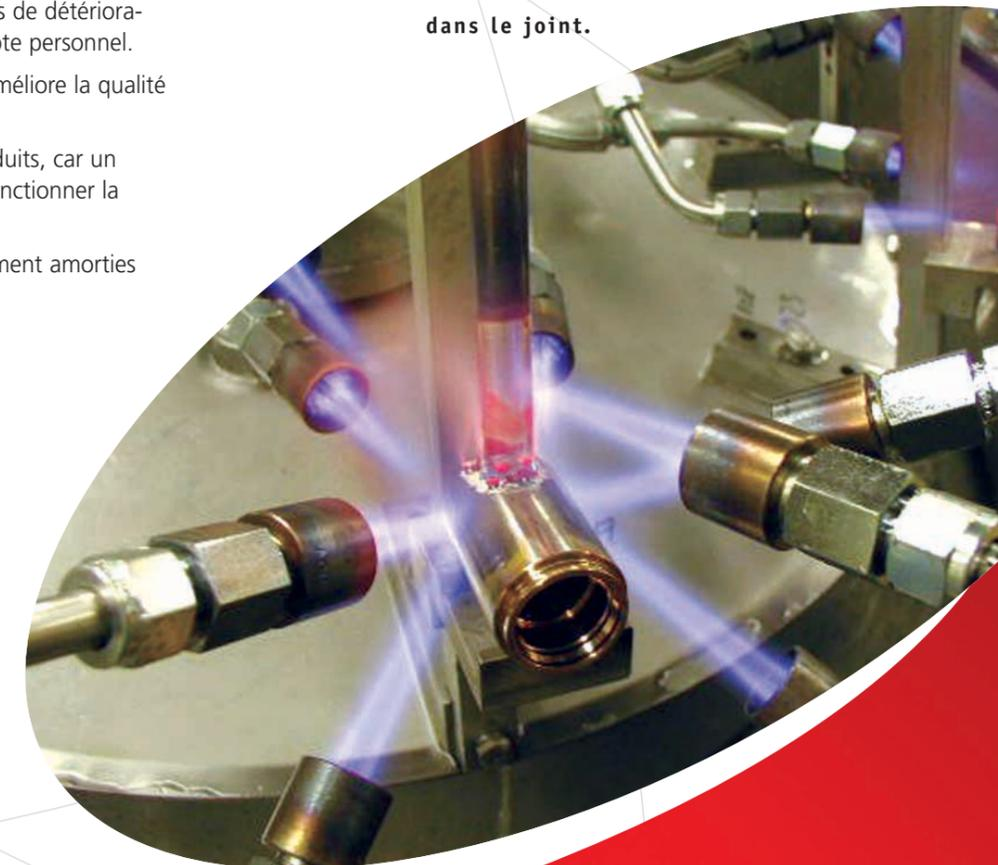
Le distributeur automatique applique un dépôt pré-réglé d'alliage en pâte Fusion au dessus du joint du tube cuivre.
