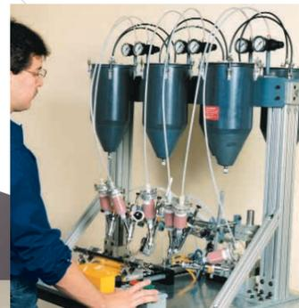
Ce robot, fonctionnant sur un seul axe, guide le pistolet applicateur pour déposer l'alliage en pâte sur les tubes à la base des joints.
