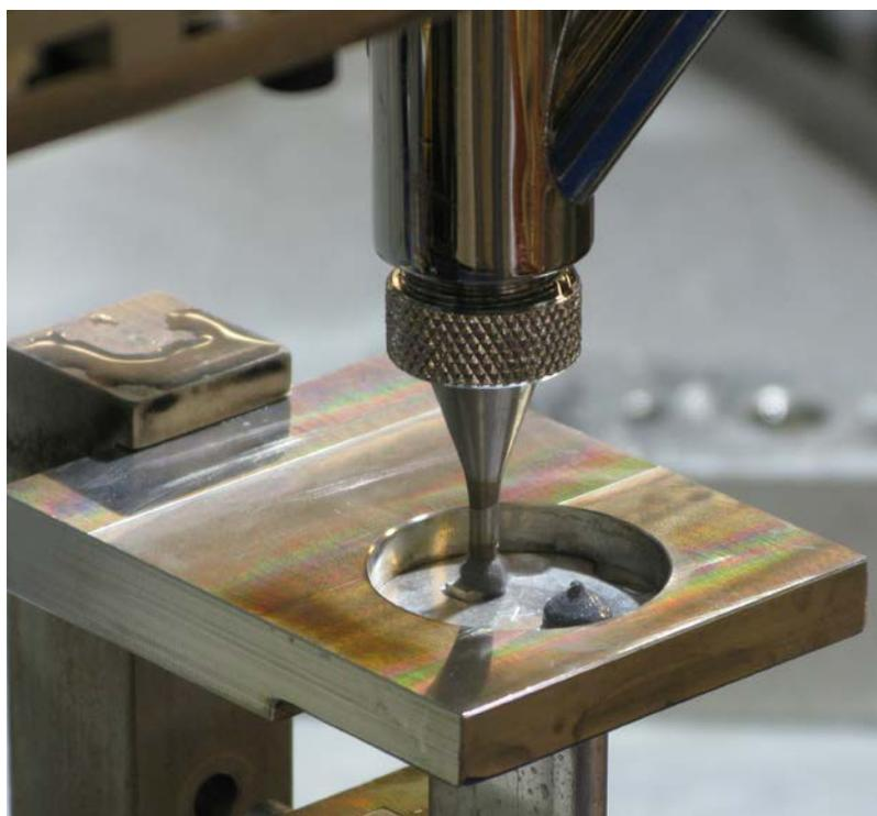
**Sopra a destra:** Normalmente, le macchine Fusion sono progettate per funzionare con un solo operatore che manualmente carica e scarica i pezzi. **In centro a destra:** Un riscaldamento preciso fa scorrere il metallo di apporto in modo uniforme nell'area di giunzione. **Sotto a destra:** Un distributore automatico applica quantità già dosate di lega in pasta Fusion ai giunti di alluminio.
